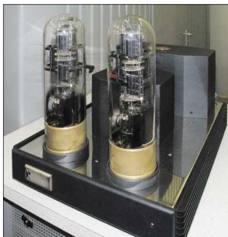
Kronzilla-SD-Röhrenendstufe: MOSFETs treiben die beiden armdicken Audio-Trioden.
