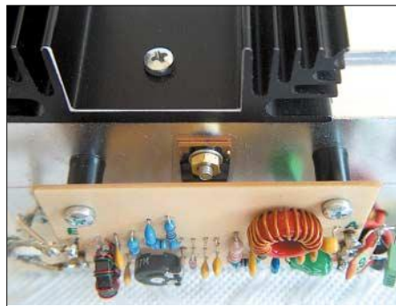
Bild 7: Montagevorschlag für Platine und VMOS-Transistor Fotos: DM2CQL
