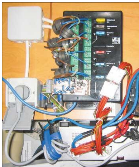
Klappferrite, Drosseln und Kondensatoren ...
