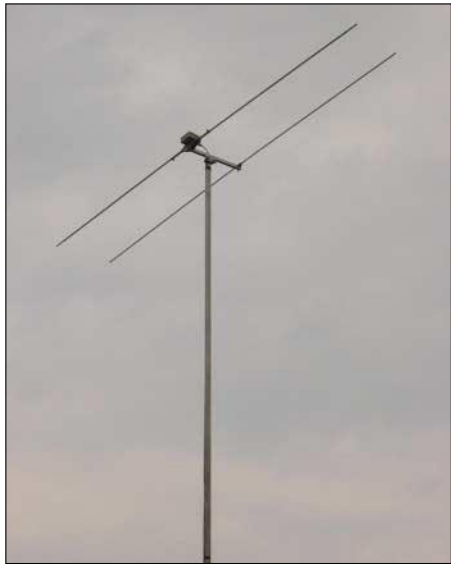
Bild 3: Die 2-Element-12,5- \Omega -Yagi fertig aufgebaut
