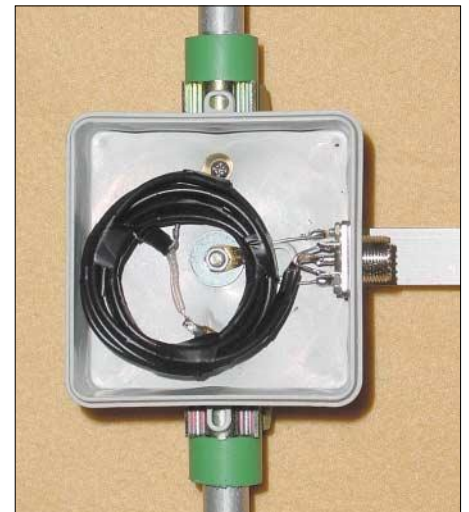
Bild 9: Anpassleitung als Kabeldrossel aufgewickelt
