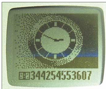
Bild 2: Zwölfstellige Positionsanzeige auf dem Handy-Display im modifizierten Gauß-Krüger-Format; der Rechtswert lautet 3442540, der Hochwert 5536070.
