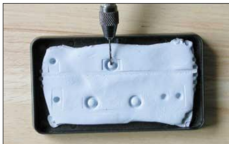
Bild 5: Mit einem dünnen Bohrer lassen sich Löcher in den Markierungen der Durchbrüche auf der Rückseite anbringen, die danach nur noch zu vergrößern sind. Fotos: G4TIC
