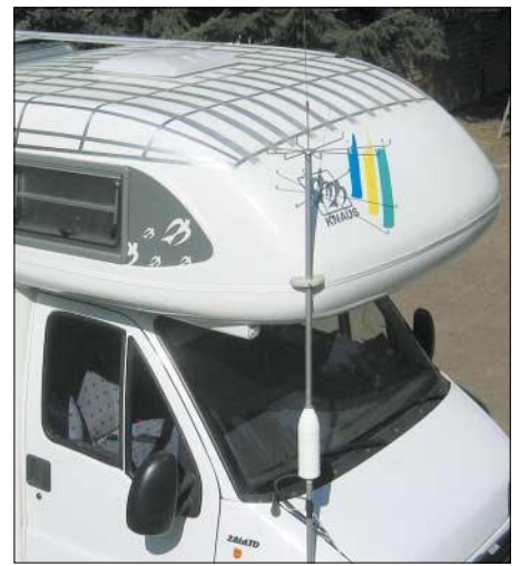
Die HF-Abschirmung mit metallischer Klebefolie komplettiert den Faradayschen Käfig.
