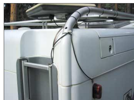
Masseleitungen an allen Ecken: hinten – oben – rechts
