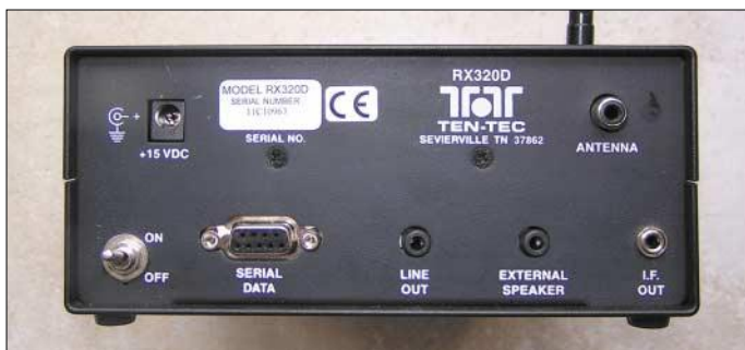
An der Rückseite befinden sich alle erforderlichen Schnittstellen, auch der beim neuen D-Modell dazugekommene 12-kHz-Ausgang.
